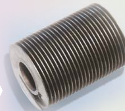
Inconel TUBE : O.D \phi 34.5 x t 3.5 SS 316L FIN : t 1.0 x H 13.9 x 7.5 F/IN
