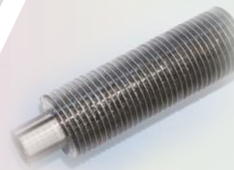
SS TUBE : O.D \phi 34.1 x t 3.4 SS FIN : t 1.0 x H 13.9 x 6 F/IN
